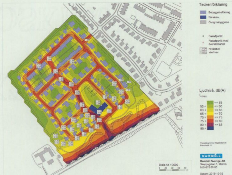
Vägtrafik, år 2040. Ljudutbredning 2 meter ovan mark och punktberäkning vid fasad för bostäder – Max ljudnivå. Bild: Rambøll.
